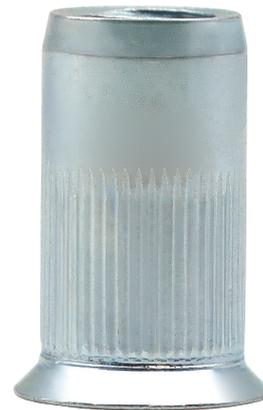
Sie vereint die Vorzüge der Abdeckung großer Klemmbereiche sowie die Rändelung für eine hohe Verdrehsicherheit. Die lang ausgeführte Längsrändelung führt zu gleichmäßigem Setzverhalten über den gesamten Klemmbereich und einem sehr großen Schließkopf.
